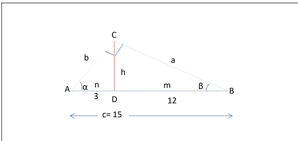
Aplicando el teorema del cateto en los triángulos ABC y ADC (son semejantes porque son rectángulos y tienen común el ángulo  $\alpha$ )
